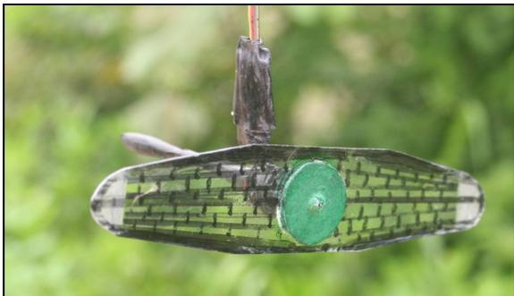
Abb. 19: Ishizawa`s Libellenpropeller, elektrisch betrieben
