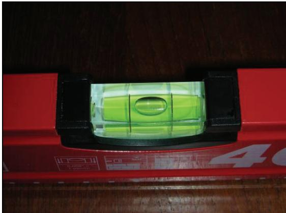
Abb. 1: Das Herzstück einer Wasserwaage heißt bekanntlich ‚Libelle‘. Was aber hat das mit der Insektenfamilie zu tun?
